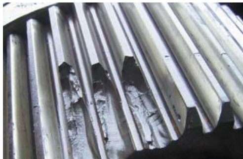
Рис. 1. Поломка зубьев зубчатого колеса ( u = 2,5 )
