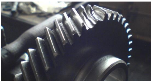
Рис. 3. Злам зубів косозубого колеса приводу подачі стола вертикально-фрезерного обробного центру
