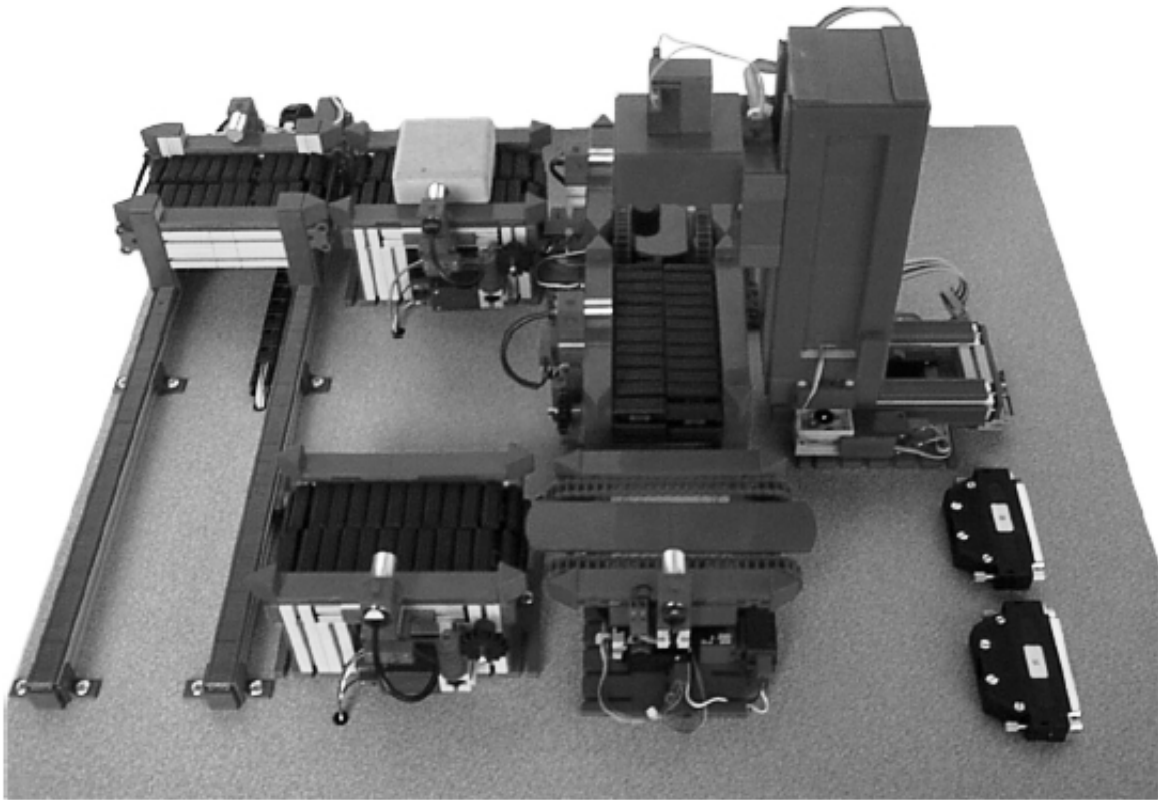
Рис. 1 – Внешний вид учебного стенда, моделирующего работу гибкой производственной линии
