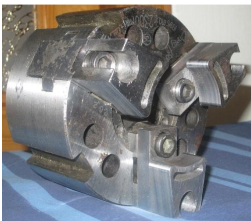
Рис. 1. Механізований токарний затискний патрон із адаптивними ЗЕ
