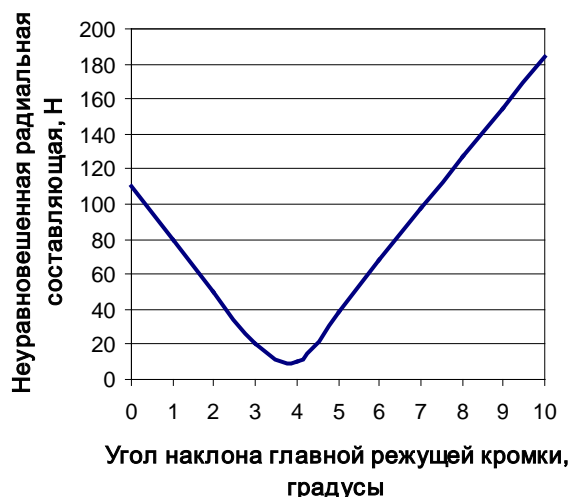
Рис. 1 – Зависимость неуравновешенной радиальной составляющей от угла наклона главной режущей кромки периферийной пластины
