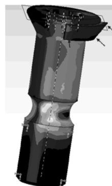
Рисунок 2 – Напряженно-деформированное состояние винта при закреплении пластины
