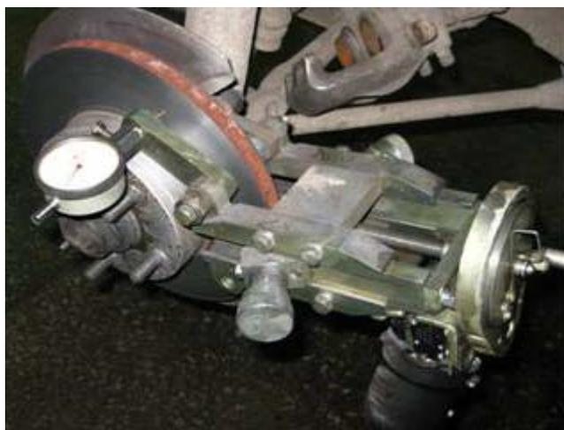
Рисунок 1 – Двурезцовый токарный модуль
