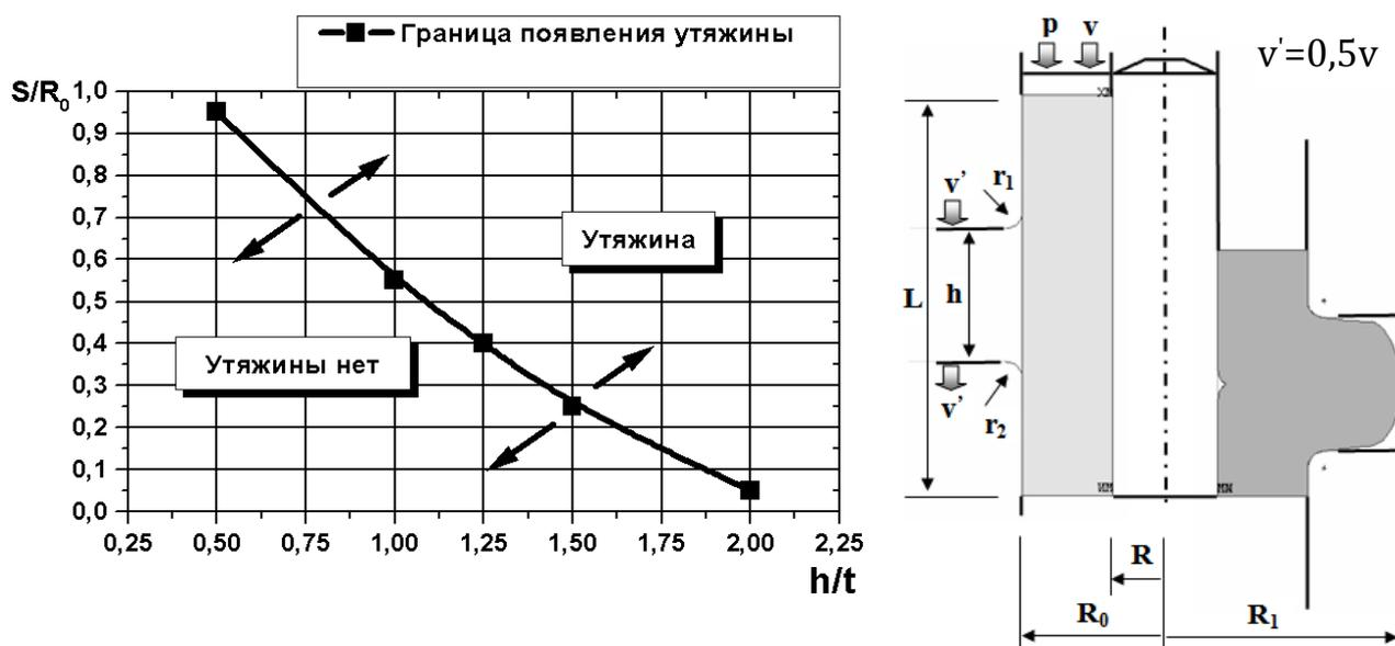
Рисунок 1 – Диаграмма для определения геометрических размеров
