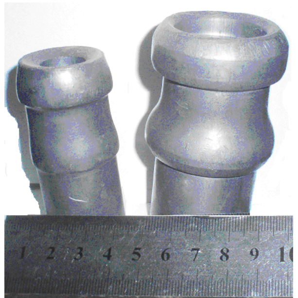
Рисунок 6.64 –Деталі з високими фланцями, отримані поздовжньо-поперечним видавлюванням в рухомих матрицях
