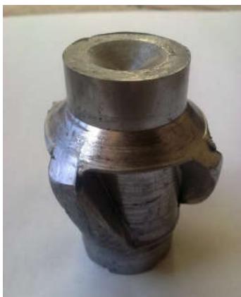
Рисунок 5.51 – Деталі з перами, отримані боковим видалюванням
