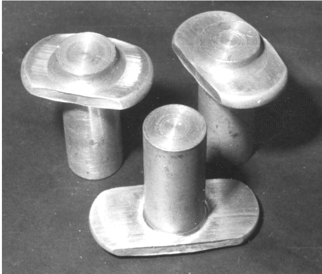
Рисунок 5.45 – Деталі з відростками прямокутного перерізу
