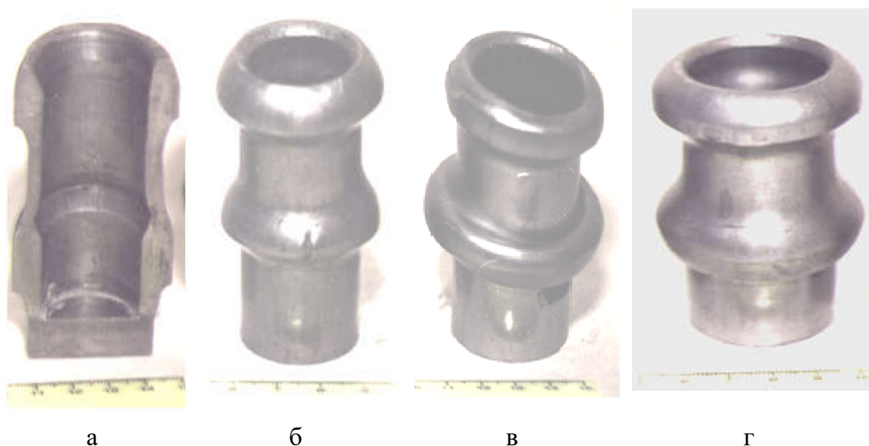
Рисунок 6.67 – Види дефектів при видавлюванні в рухомих матрицях: утягнення на стінці в області фланця (а); розрив фланця (б); не перпендикулярність фланця осі виробу (в); невиконання форми (г)
