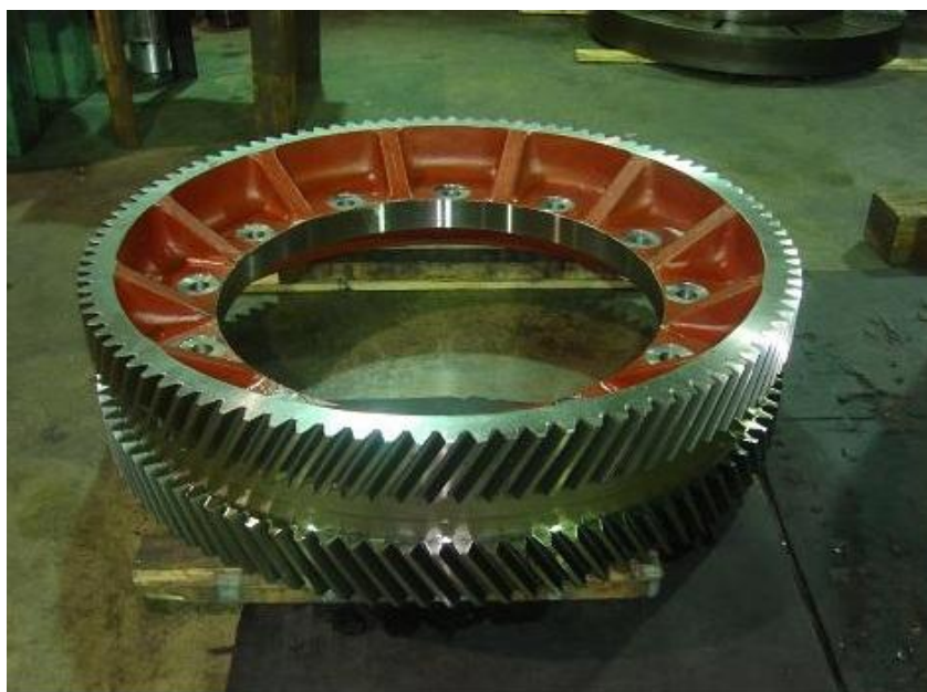
Рисунок 4.5 – Шевронне зубчасте колесо m = 12 мм; z = 110 після чорнового зубофрезерування та об'ємного загартування
