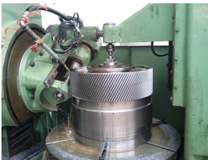
Рисунок 1.2 – Оброблення шевронного колеса черв'ячною фрезою
