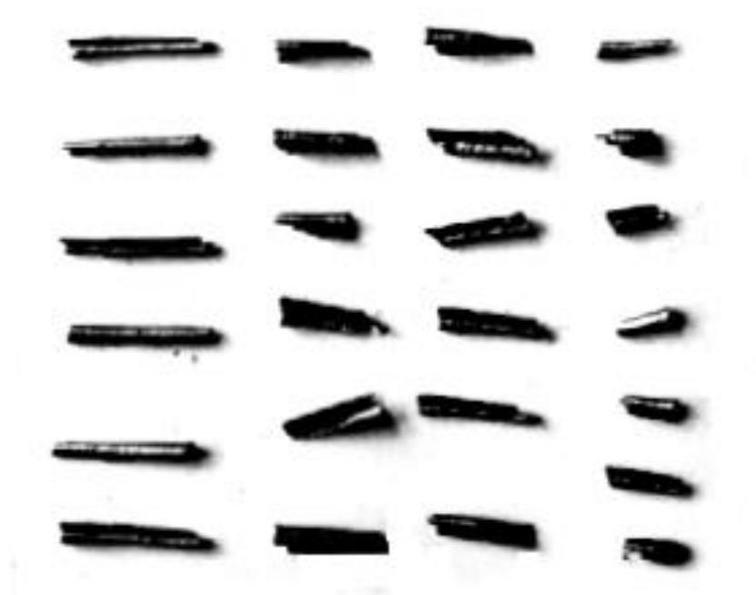
Рисунок 4.8 – Стружка, що зрізується фрезою з роздільною схемою формоутворення, при оброблюванні зубчастих вінців m = 20 мм; z = 316 .
