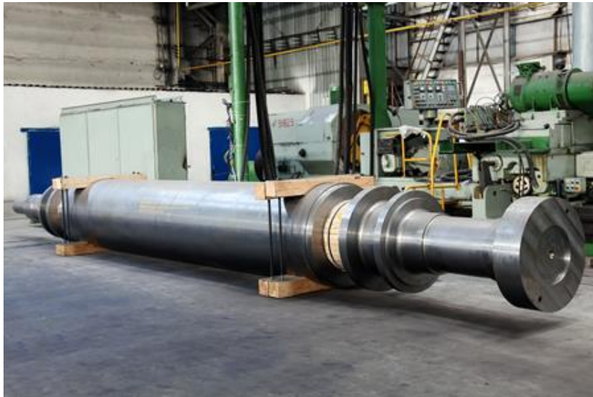
Рисунок 1.4 – Ротор генератора (вага 43125 кг)
