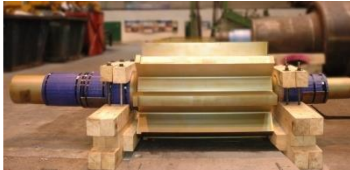
Рисунок 1.6 – Вал ротора (вага 5800 кг)
