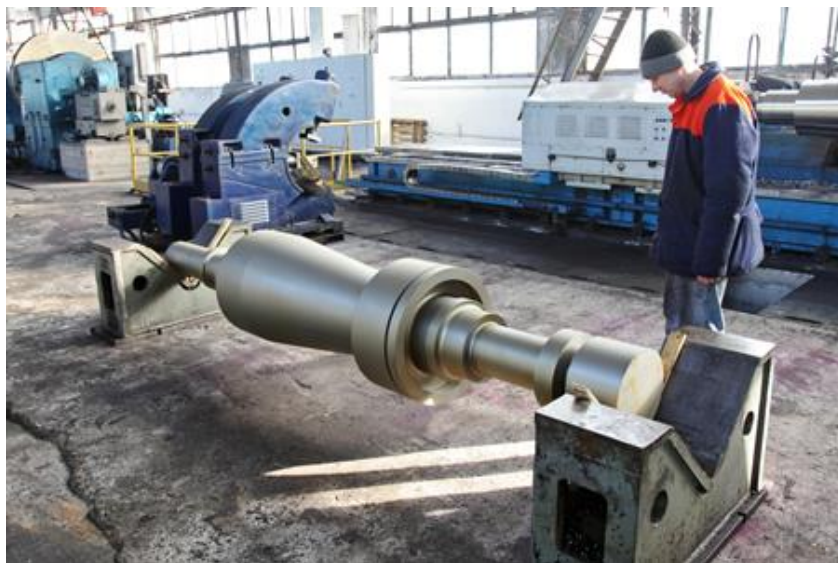
Рисунок 1.5 – Ротор турбіни (вага 3225 кг)
