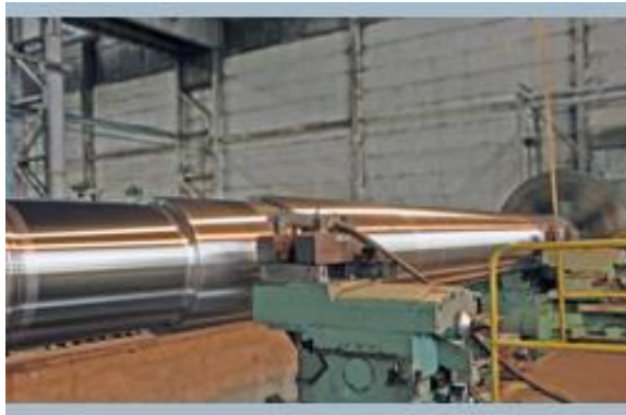
Рисунок 1.11 – Гребний вал (вага 61000 кг)
