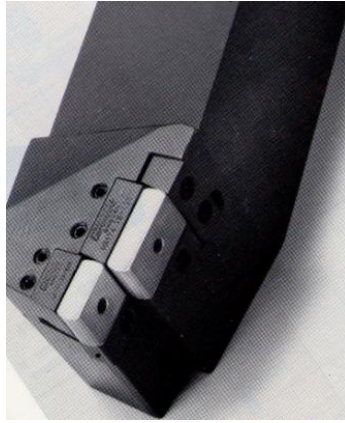
Рисунок 1.5 – Ступінчастий збірний різець з механічним кріпленням тангенціально розміщених змінних різальних пластин
