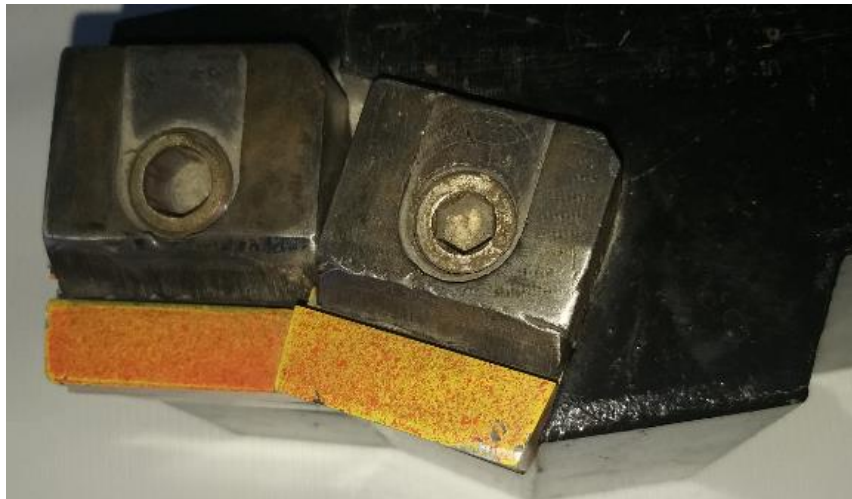
Рисунок 7 – Різальна частина ступінчатого збірного різця
