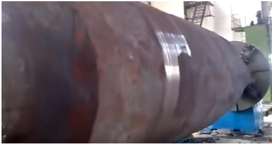
Рисунок 1 – Чорнова обробка деталі на важкому токарному верстаті
