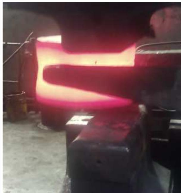
Рисунок 8.32 - Схема локальной осадки поковок типа дисков
