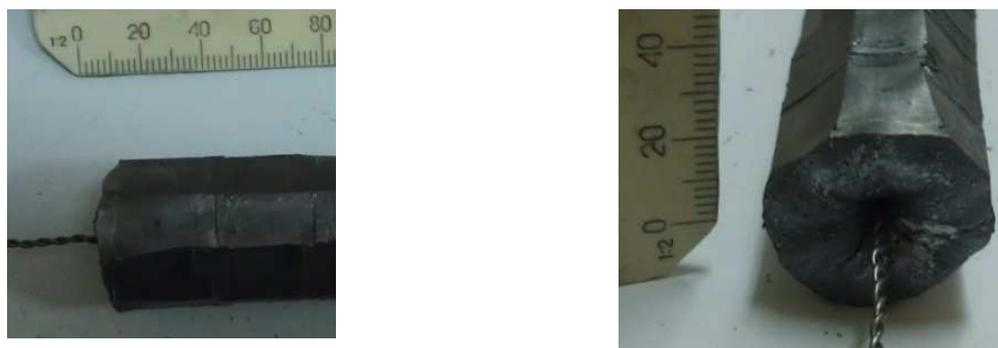
Рисунок 5.33 - Замер глубины зажима торцевой поверхности заготовки щупом
