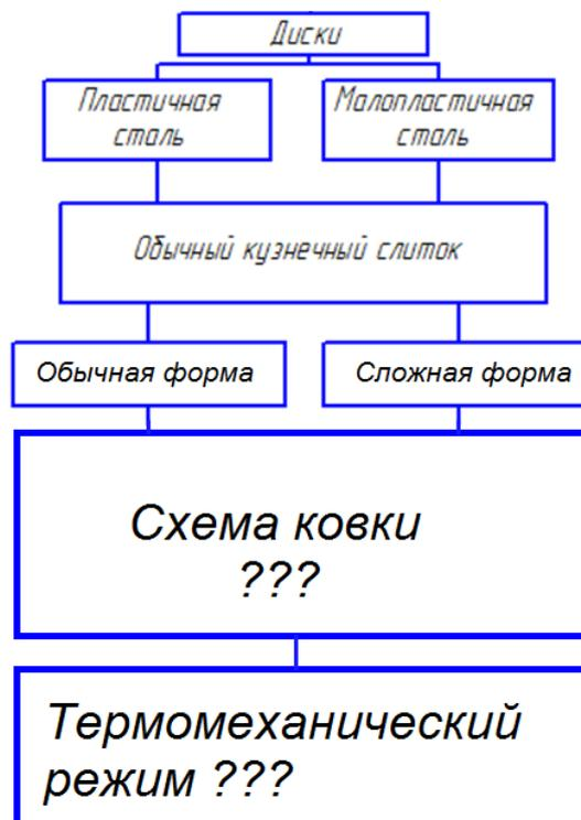
Рисунок 1.56 - Неопределённости при проектировании процессов ковки
