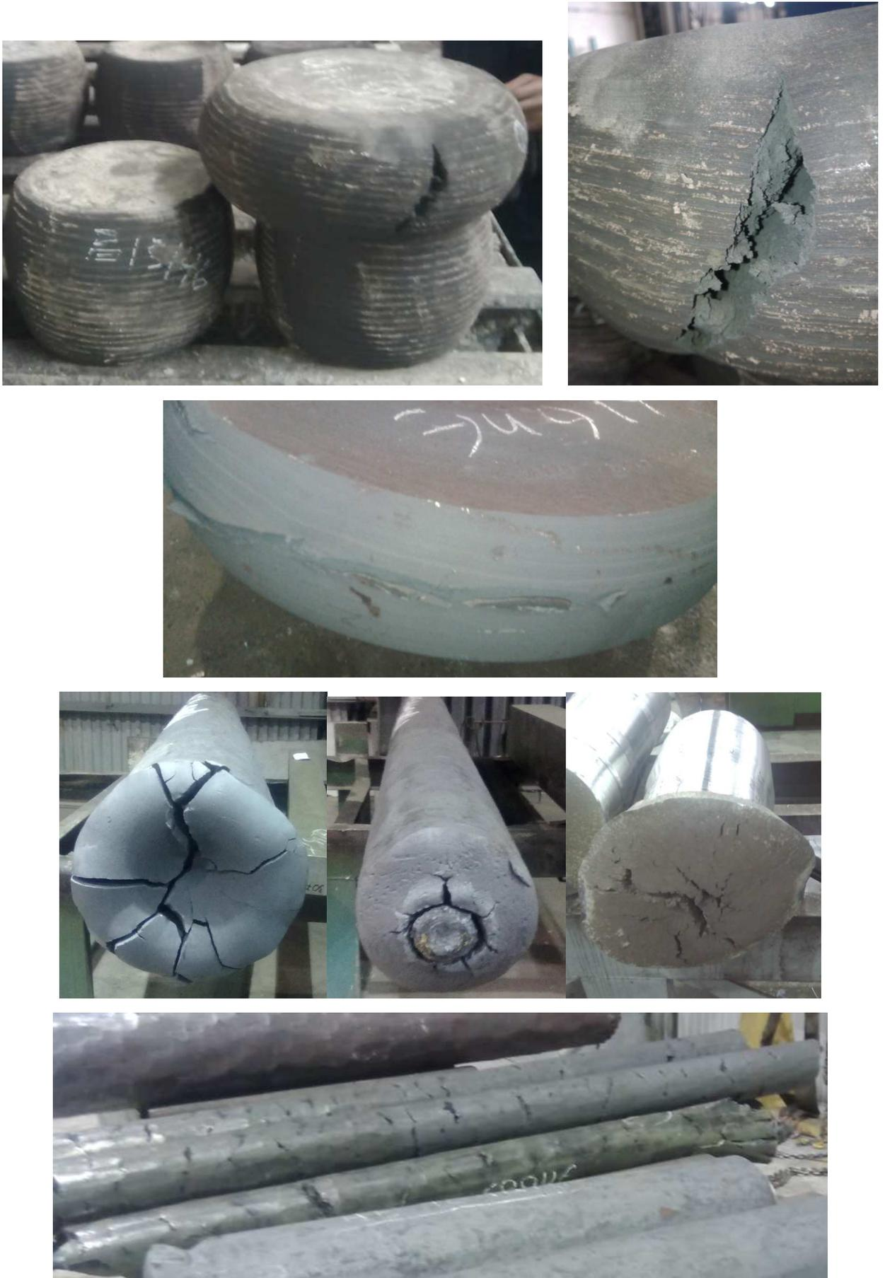
Рисунок 3.1 - Образование трещин в различных типах поковок
