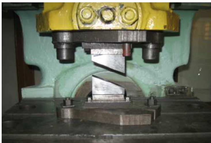
Рисунок 4.14 - Общий вид штампа установленного в прессе со скошенными бойками
