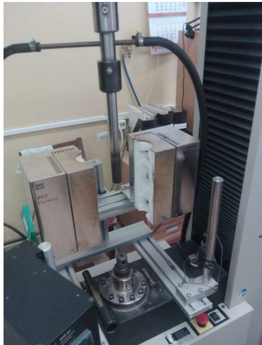
Рисунок 2.19 - Установка MTS Insight для испытаний стальных образцов при повышенных температурах на осадку и растяжение
