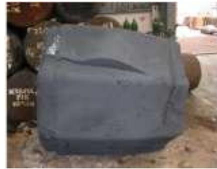
Рисунок 5.36 - Поверхностная трещина, образованная в процессе осадки
