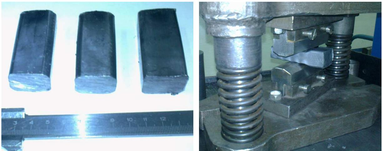
Рисунок 4.53 - Экспериментальная оснастка и свинцовые заготовки
