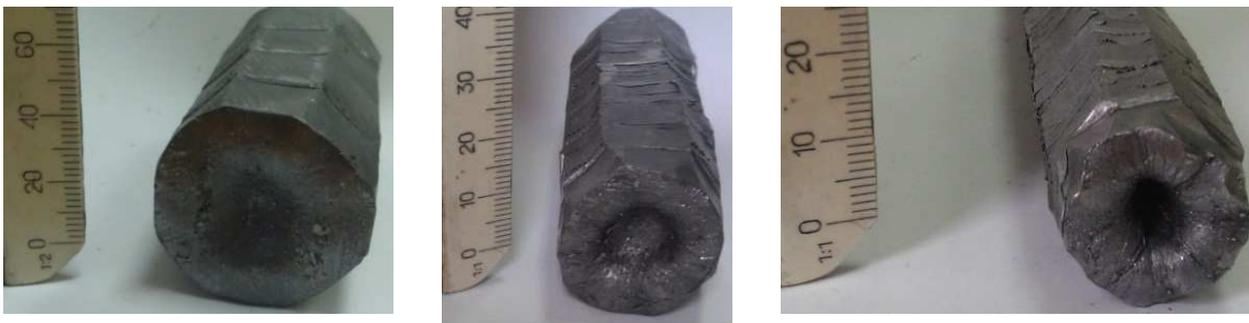
Рисунок 5.32 - По стадийное образование вогнутости торцевой поверхности заготовки в ходе протяжки
