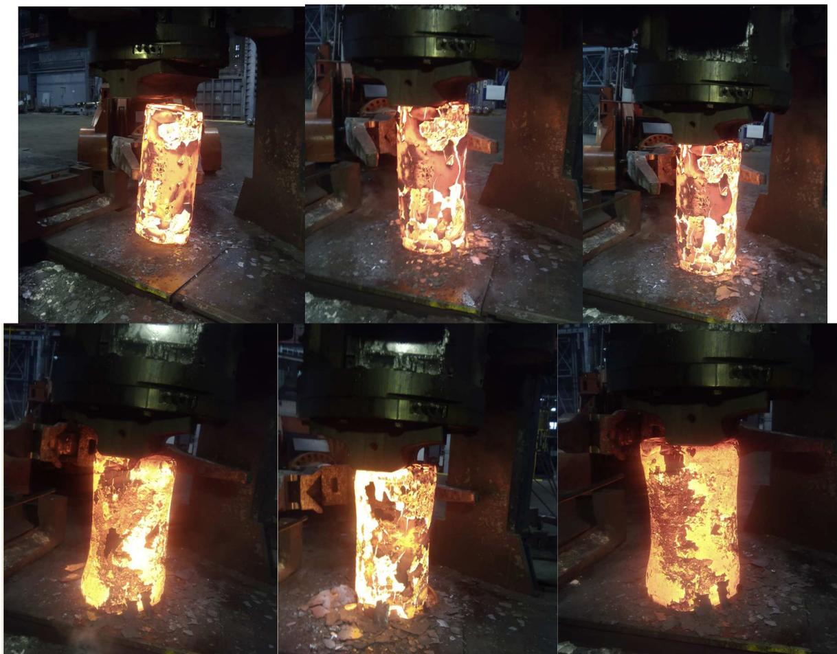
Рисунок 8.35 - Профилирование заготовки узким бойком на первой стадии осадки
