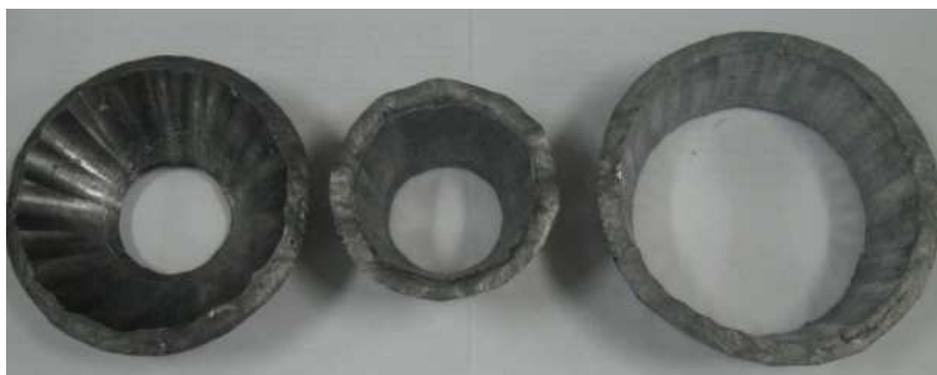
Рисунок 7.7 - Конические кольца, полученные экспериментально
