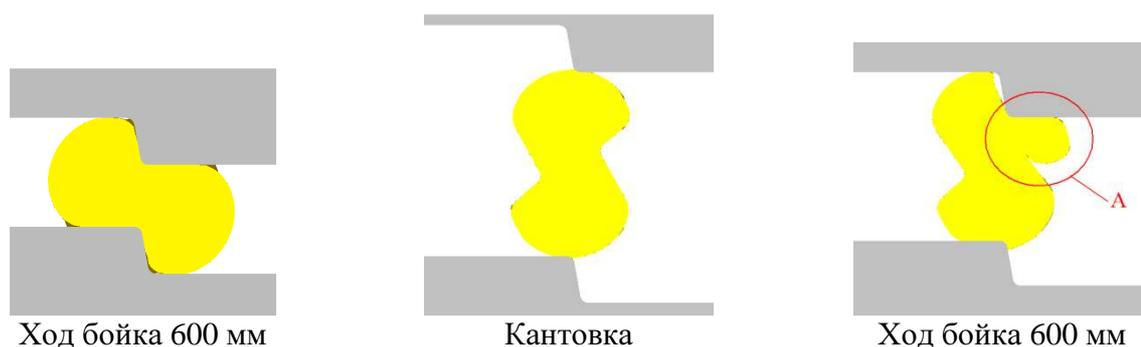
Рисунок 4.32 - Формоизменение поперечного сечения заготовки при ковке ступенчатым бойком с нулевым перекрытием и высотой уступа 300 мм
