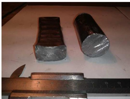
Рисунок 4.41 - Общий вид инструмента и заготовок для проведения экспериментальных исследований протяжки ступенчатыми бойками
