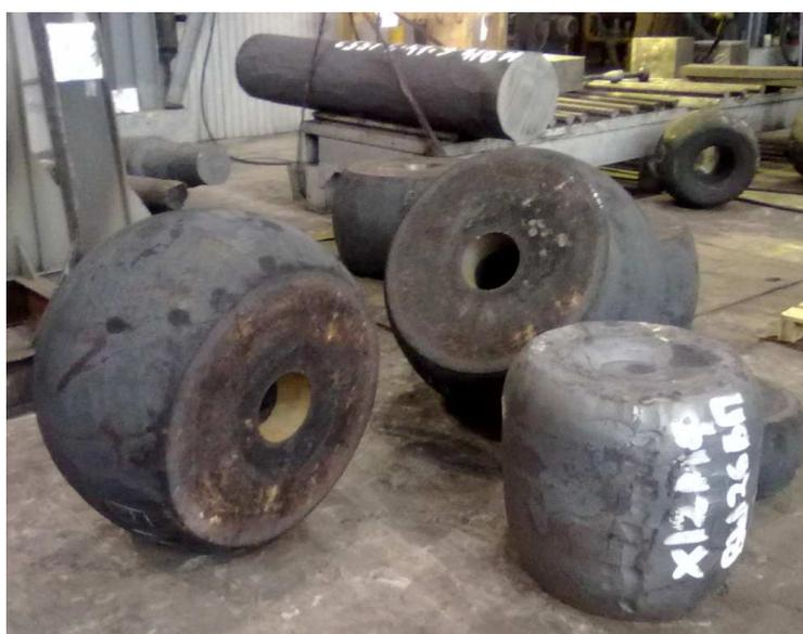
Рисунок 8.36 - Общий вид поволок из стали X12MФ, полученных осадкой
