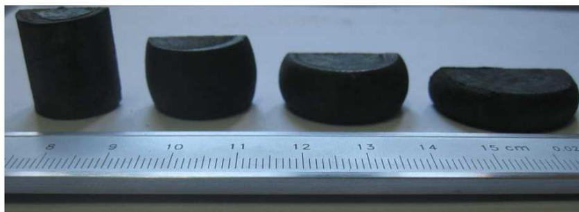
Рисунок 6.36 - Общий вид цилиндрических образцов после осадки
