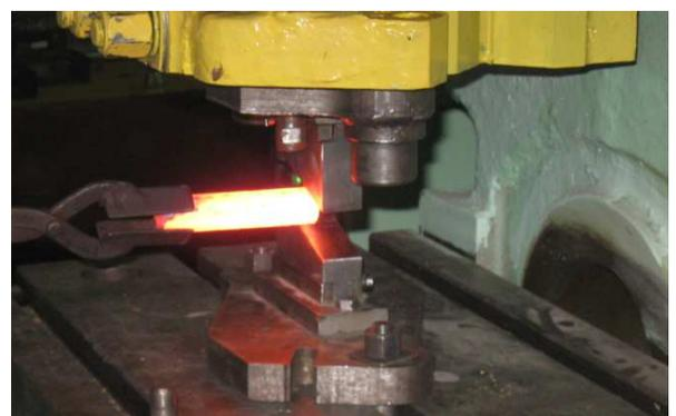
Рисунок 4.17 - Протяжка заготовки бойками плоскими и скошенными в плане
