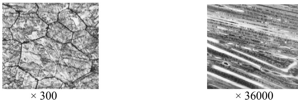
Рис. 1. Микроструктура вакуумных конденсатов системы Ni-65 ат. % Cr, полученных при температуре осаждения 1100 °С
