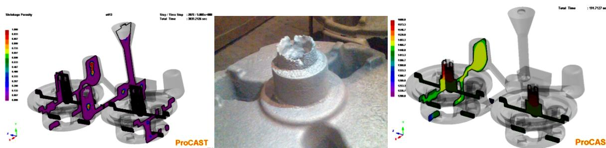
Рис. 3. Отливка «Водило», полученная по технологии с применением экзотермического элемента, и литейный блок отливки, выполненной при помощи СКМ ЛП ProCAST
