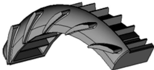
Рис. 1. Отливка «Сектор» для гидроэлектростанций
