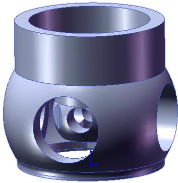
Рис. 1. Отливка «корпус рабочего колеса»
