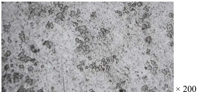
Рис. 1. Типичная микроструктура лигатуры Al–2 % Sc
