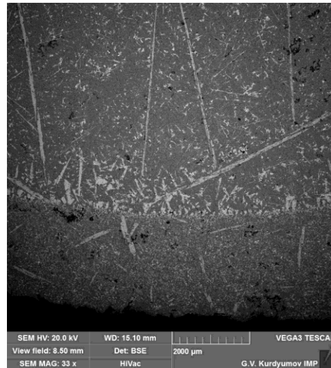
Рис.1. Мікроструктури дослідного зразка 1 після осадження без модифікування W
