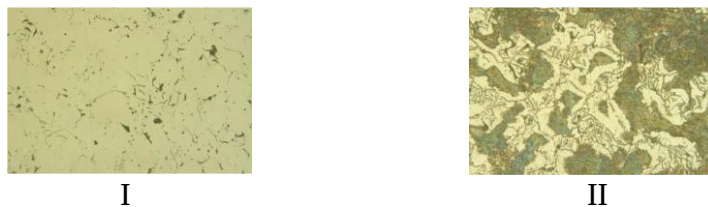
Рис. 1 Мікроструктура зразка вихідного чавуну: I – не травлений мікрошліф; II – мікрошліф після хімічного травлення
