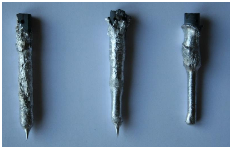
Рисунок 1 – Образцы различных видов чугунов после выдержки в алюминии: а) серый чугун; б) белый чугун; в) высокопрочный чугун.
