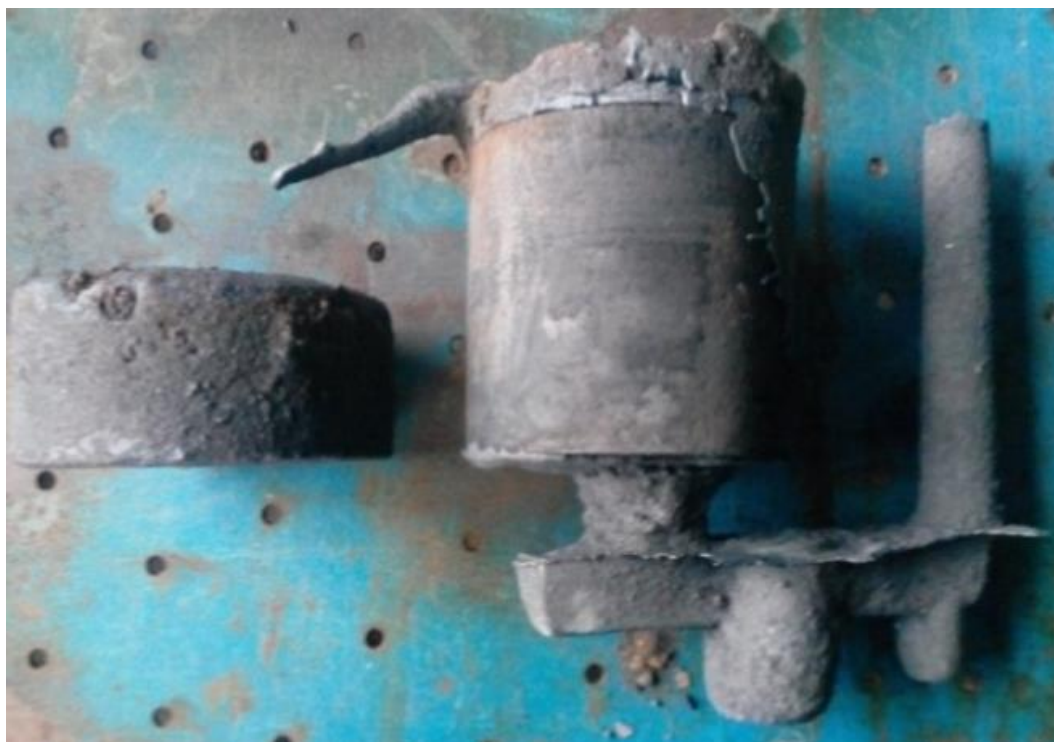
Рисунок 4 - Внешний вид полученной двухслойной отливки «Цилиндр»
