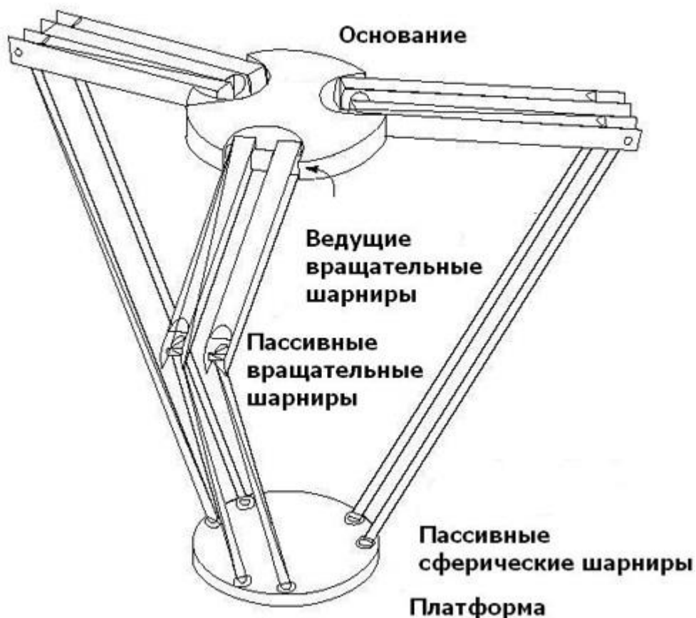
Малюнок 1.3 - Схема дельта-механізму
