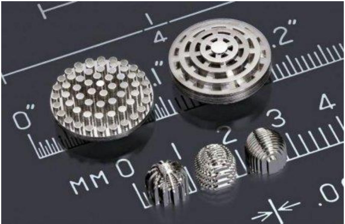
Рис 10.6 – Металеві моделі роздруковані на 3D-принтері з роздільною здатністю 1000 мікрон
