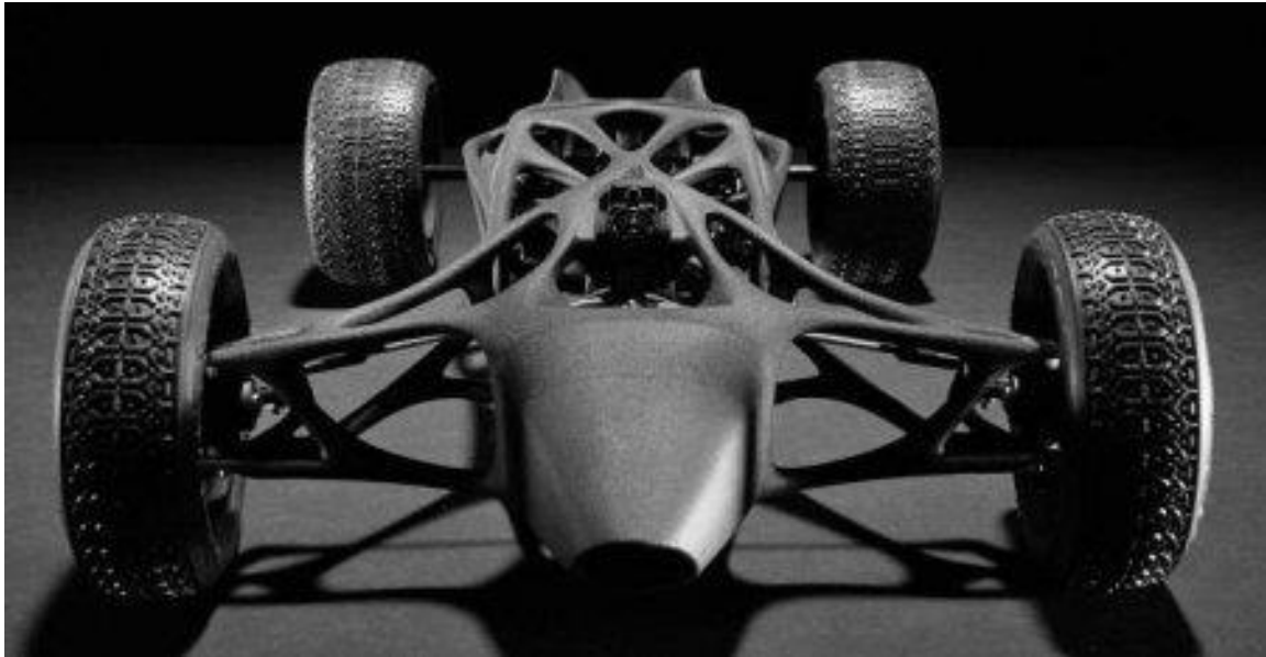
Рис 10.5 – Каркасна модель боліда роздрукована за допомогою 3D-принтера
