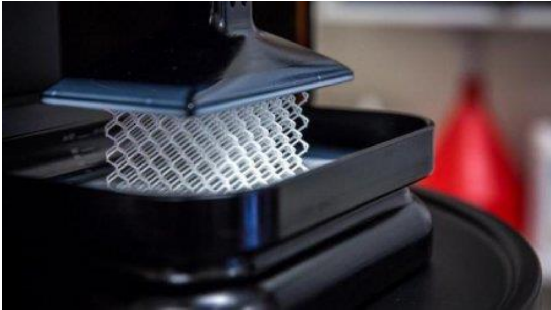
Рис. 10.1 – Каркасна модель в процесі побудови на 3D-принтері
