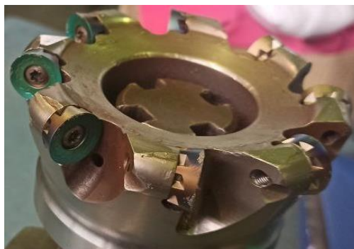
Рисунок 1 – Фреза з не рівномірним зносом пластин
