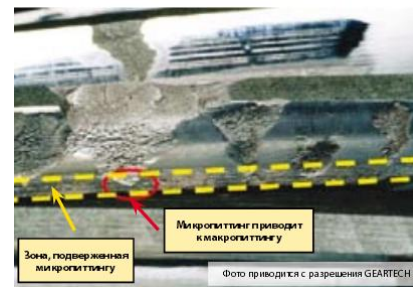
Применение специального масла для защиты от микропиттинга a – вершины пар трения до; б – вершины пар трения после не соприкасаются
