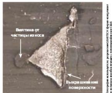
Вмятина от частицы износа, ведущая к выкрашиванию поверхности зубчатых колес
