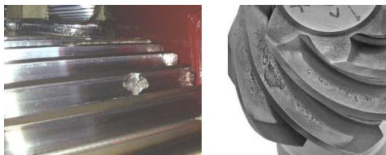
Шестерни с кратным передаточным отношением: микропиттинг привел к сколу части боковой поверхности зубьев
