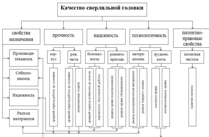
Рис.4 – Иерархическая структура свойств, составляющих качество инструмента для глубокого сверления на стадии его эксплуатации
