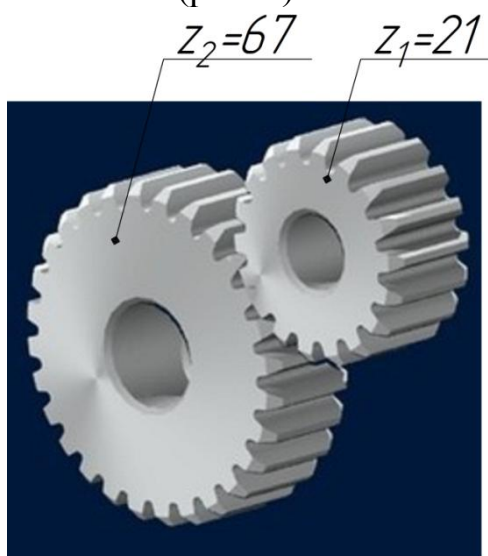
Рис. 4 – Предлагаемая некрatная схема зацепления зубчатых колес привода главного движения станка VDF-1200: u= 3,19047
