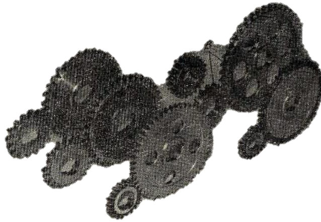
Рис. 2 – Эвольвентные зубчатые пары основных типоразмеров: m = 3; 4 и 5 мм; z_1 = 16 \dots 21 ; z_2 = 32 \dots 52 ; b=10 мм; a = 100 \dots 150 мм; степень точности 6 - 7 по ГОСТ 1643—81
