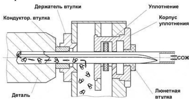
Рис. 8 – Отвод стружки в процессе сверления
