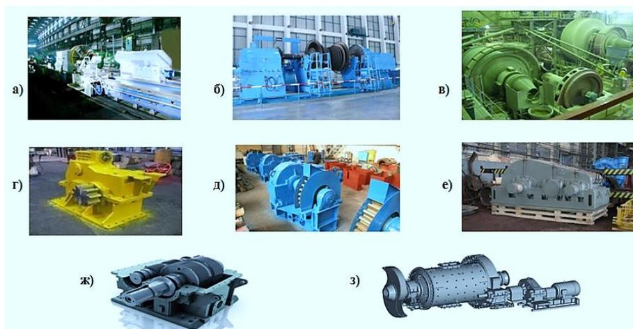
а) Тяжелый токарный станок модели 1К670Ф3 ( $m = 14-24\text{мм}$ ); б) Тяжелый токарный станок модели РТ95 ( $m = 12-16\text{мм}$ ); в) Рудоразмольная мельница ( $m = 24-65\text{мм}$ ; г) Редуктор шлаковоза ( $m=20-46\text{мм}$ ); д) Редуктор ЦДН-630 ( $m = 18-36\text{мм}$ ); е) Редуктор ЦЦ2-1250 ( $m = 20-40\text{мм}$ ); ж) Редуктор ( $m = 12-18\text{мм}$ ); з) Рудоразмольная шаровая мельница ( $m = 20-50\text{мм}$ )
