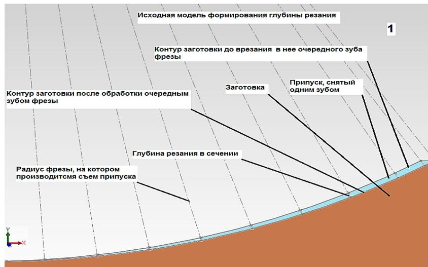
Рис.10 – Исходная модель формирования процесса формообразования
