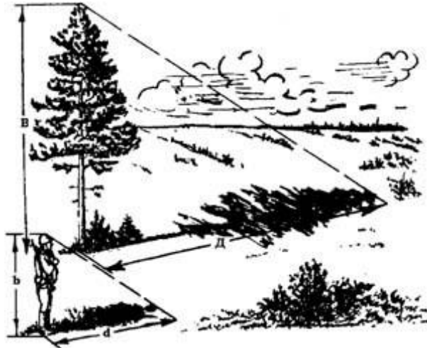
Рисунок 4.7 – Визначення висоти предмета за його тінню
