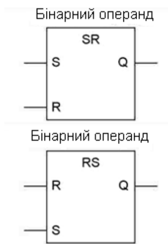
Рисунок 2.8 - Блоки елементів пам'яті SR і RS
