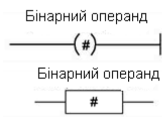
Рисунок 2.9 - Позначення коннектора в LAD і FBD
