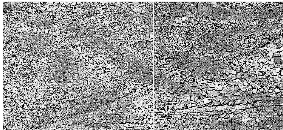
Микроструктура участка сварного шва и околошовной зоны сварного соединения до и после прокатки участка сварного шва
