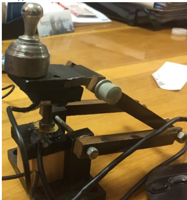
Рисунок 5.2. – Пристрій для акустичної діагностики зусилля затиску.
