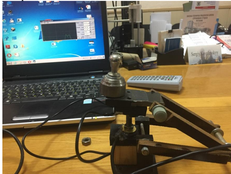
Рисунок 5.3 – Установка для зняття частотної характеристики
