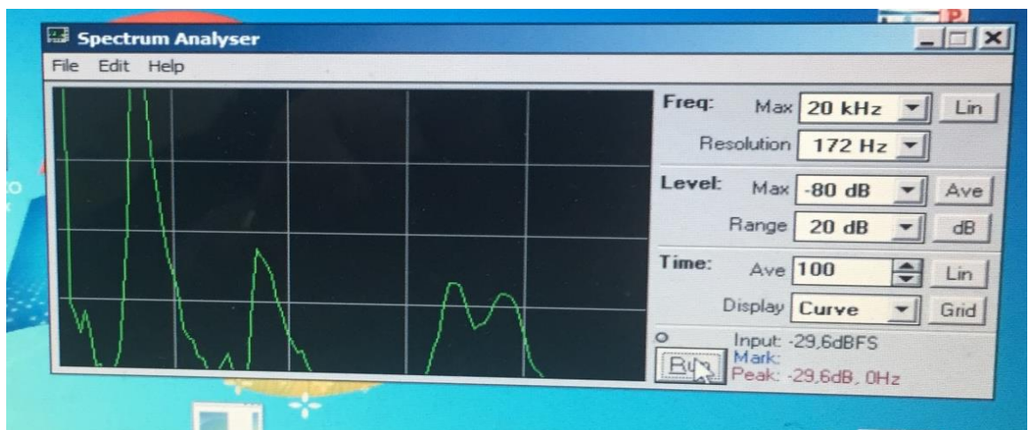
Рисунок 5.4. – Налаштування програми Audio SweepGen. Для зняття частотної характеристики використовується програма Spectrum Analyser
