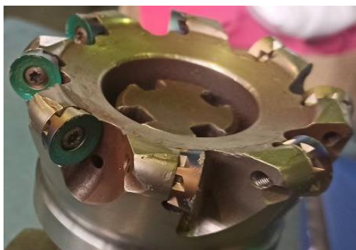
Рисунок 1 – Фреза з не рівномірним зносом пластин
