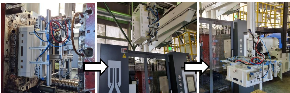
Рисунок 1 - Застосування робота для знімання готового виробу
