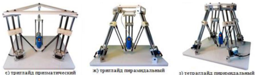
Рисунок 2 – Компоновки на основі механізмів паралельної структури типу «триглайд» або тетраглайд
