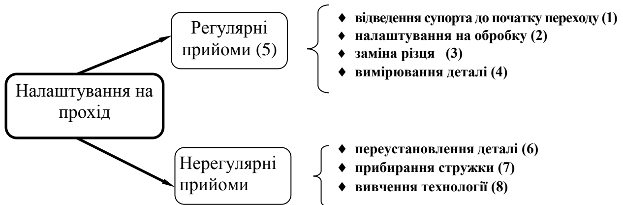
Рисунок 6.8 – Структура часу для виконання комплексу трудових прийомів при налаштуванні на перехід
