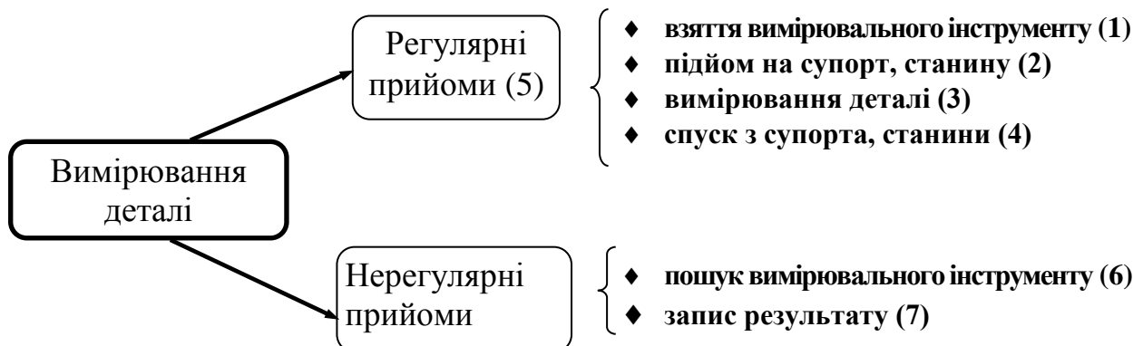
Рисунок 6.12 – Структура регулярних і нерегулярних трудових прийомів при вимірі деталі
